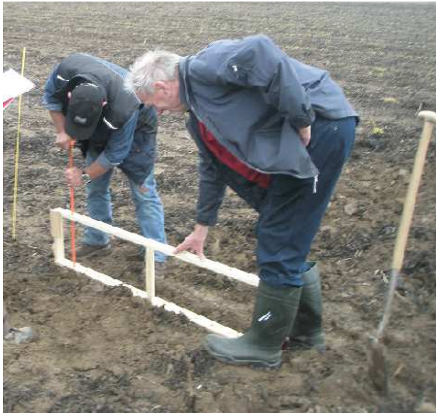
Afb. 5: Profilometer [eigen foto]
